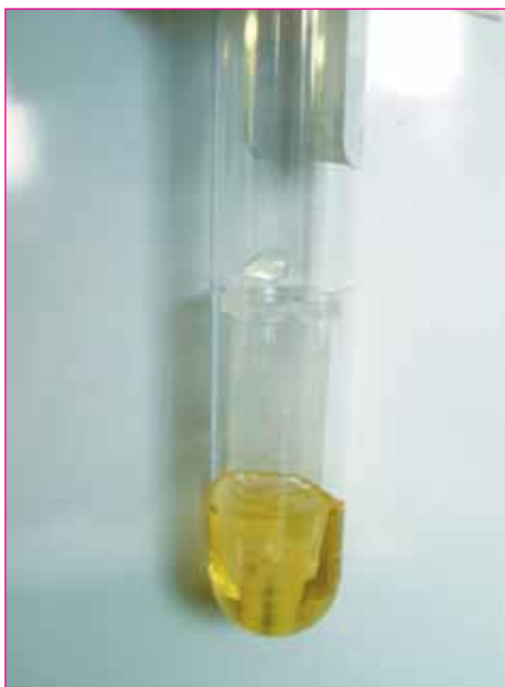
Fig. 5 - Campione chiuso con cemento Portland: terreno di coltura limpido. Confronta con Fig. 4.
